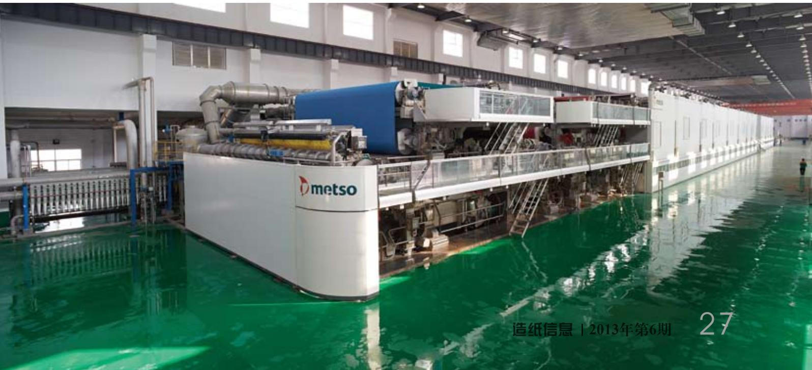
模块化生产线的每一处改善均能带来节能的效果。而其运行收益则来源于造纸机的高效率，即高效使用能源和高效利用资源的过程以及生产过程的高车速。据美卓公司称，开发 OptiConcept M 具有巨大的节能潜力：采用有效的磨浆、碎浆、筛选和浆料混合，浆料制备过程节能潜力高达 10%；采用新型真空系统概念、有效地脱水，湿部节能潜力高达 20%；采用优化气罩控制、有效蒸汽冷凝水系统、运行性能针对不同纸种进行控制以及有效的热回收，干燥部节能潜力高达 20%；采用有效的干燥和空气系统，完成部节能潜力高达 20%。高效利用资源方面体现在可以使用便宜的原材料替代或部分替代昂贵的原材料以及降低水耗上。
