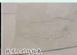
长纤维混合时容易出现的问题
