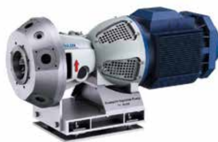
温德-苏尔寿 TIP 喷射泵安装在流浆箱前的 上浆管上，用于喷射和闪急混合添加 剂或者化学品。配备 TIP 泵的创捷系统能 够轻松而均匀地混合 5 ~ 20 mm 的合成纤维 以及生物质基纤维
