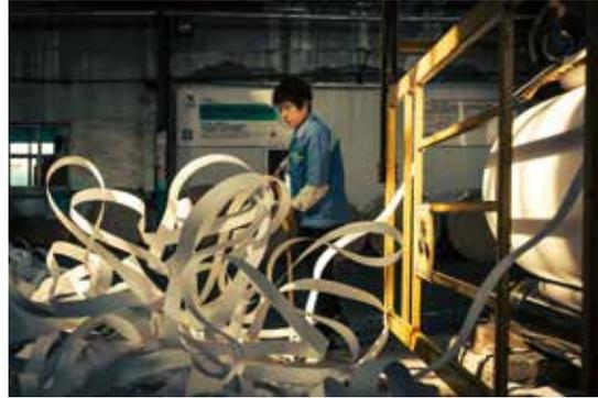
**工作中的舞蹈** 老式的复卷机将纸边切除，工人师傅正在归拢纸带。纸带飞舞划出美丽的弧线，不如师傅年复一年工作中娴熟的姿势
