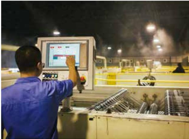
**自动化控制** 切纸机实现全自动化控制，只需输入数值就可以分切成客户要求的宽度
