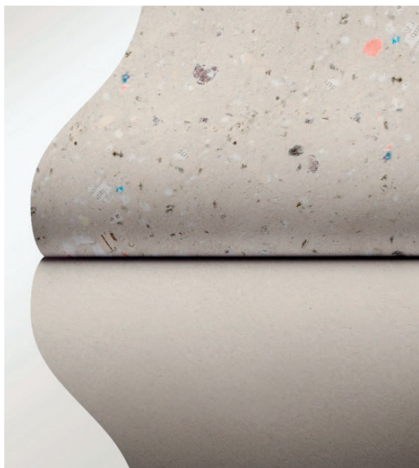
图2 经热分散系统处理后浆中尘埃及斑点明显减少
